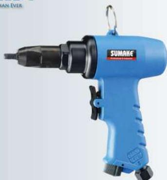
La remachadora de tuercas neumáticas instala medidas de M5 a M10 en acero y aluminio, el torque generado es utilizado para el remachado de las tuercas, gatillo con doble función para recoger y soltar el inserto remachado, la nariz estriada elimina cualquier reacción de torque durante la instalación. Para pedido indicar nariz deseada ej: para nariz M6 ST-6902-M6
