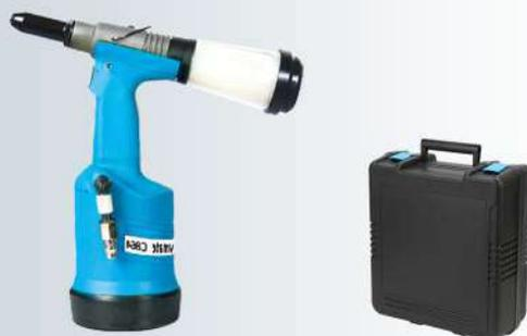
El modelo C864 pesa casi la mitad de muchas herramientas de la misma capacidad. Al igual que el modelo C848, la carcasa exterior esta fabricada en termo plástico reforzado con vidrio. El sistema universal de triple mordaza permite la instalación de remaches de 1/8" hasta 1/4" estructurales solo con el cambio de boquilla. Demas características de seguridad y operación igual a la C848.
