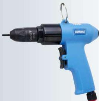
La remachadora de tuercas neumáticas instala medida de M3 a M6 en acero y aluminio, el torque generado es utilizado para el remachado de las tuercas, gatillo con doble función para recoger y soltar el inserto remachado, la nariz estriada elimina cualquier reacción de torque durante la instalación. Para pedido indicar nariz deseada ej: para nariz M6 ST-6902-M6
