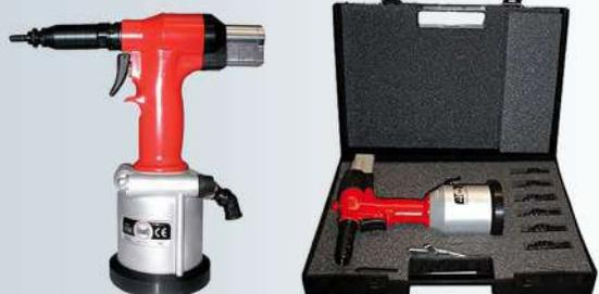
La herramienta hidroneumática RIV998 (2 fases) se utiliza para colocar las tuercas de remachebles en aluminio y acero de M3 a M12 (acero inoxidable hasta M10), y las tuercas de remache macho de M4 a M8.
